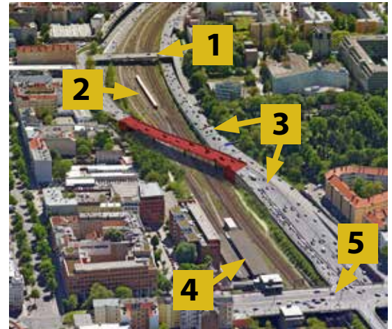
Ersatzneubau der Westendbrücke (DEGES 2022, eigene Bearbeitung) 1: Stahlbrücke Knobelsdorffstraße. 2: S-Bahn und Fernbahn. 3: Getrennte Richtungsfahrbahnen. 4: S-Bahnhof. 5: Spandauer-Damm-Brücke
